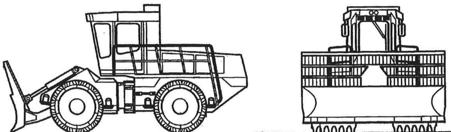
Slika 2. Prikaz radnog stroja kompaktora «BOMAG» iz uputa za održavanje i rukovanje
